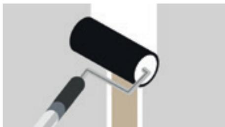
3. Dopo l'essiccazione applicare una seconda mano di stucco tramite il rullo da 18 cm.
